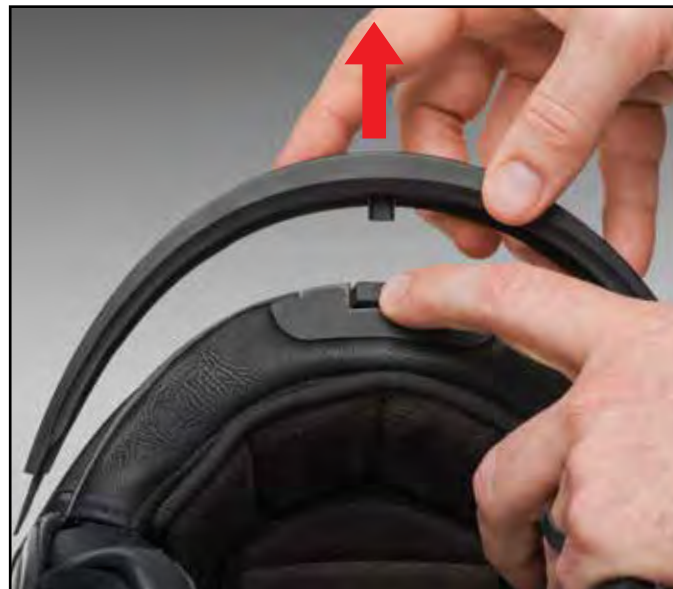
Figura 2. Tenendo premuto il pulsante di sgancio della visiera, estrarre la visiera
